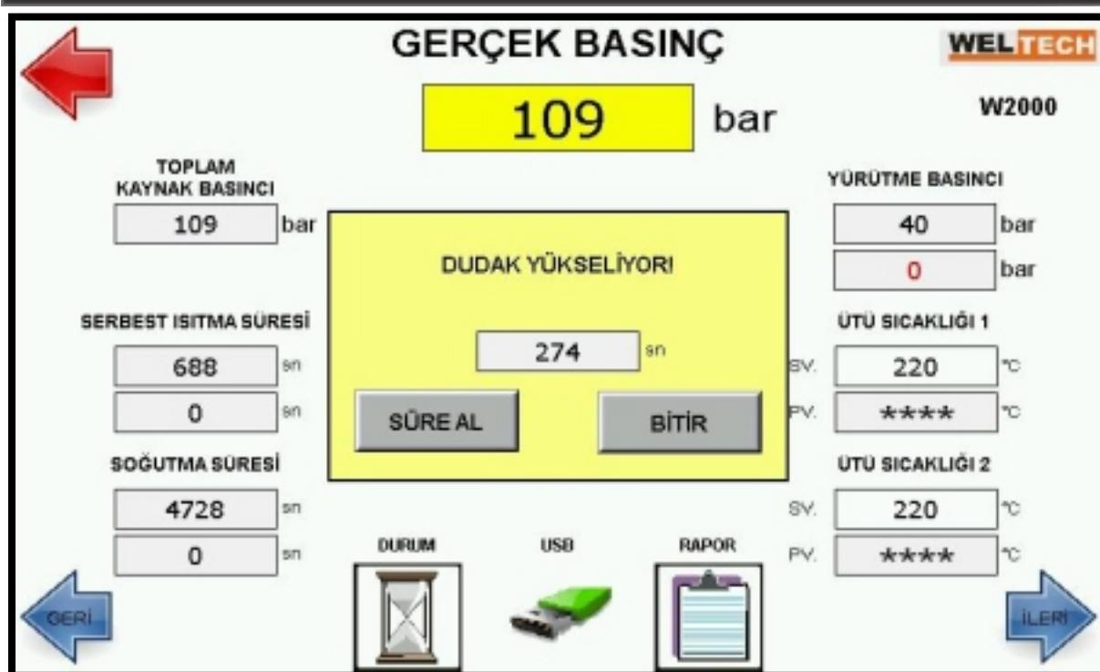
16- CNC W315 Alın kaynak makinesi dudak yüksekliği standart değere geldiği zaman basınçsız ısıtma işlemine otomatik olarak geçer. İstenen dudak yüksekliği sağlanmamışsa ekrandaki uyarı çıkar buna göre basınçlı ısıtma süresi devam eder. Dudak yüksekliği standart değere
