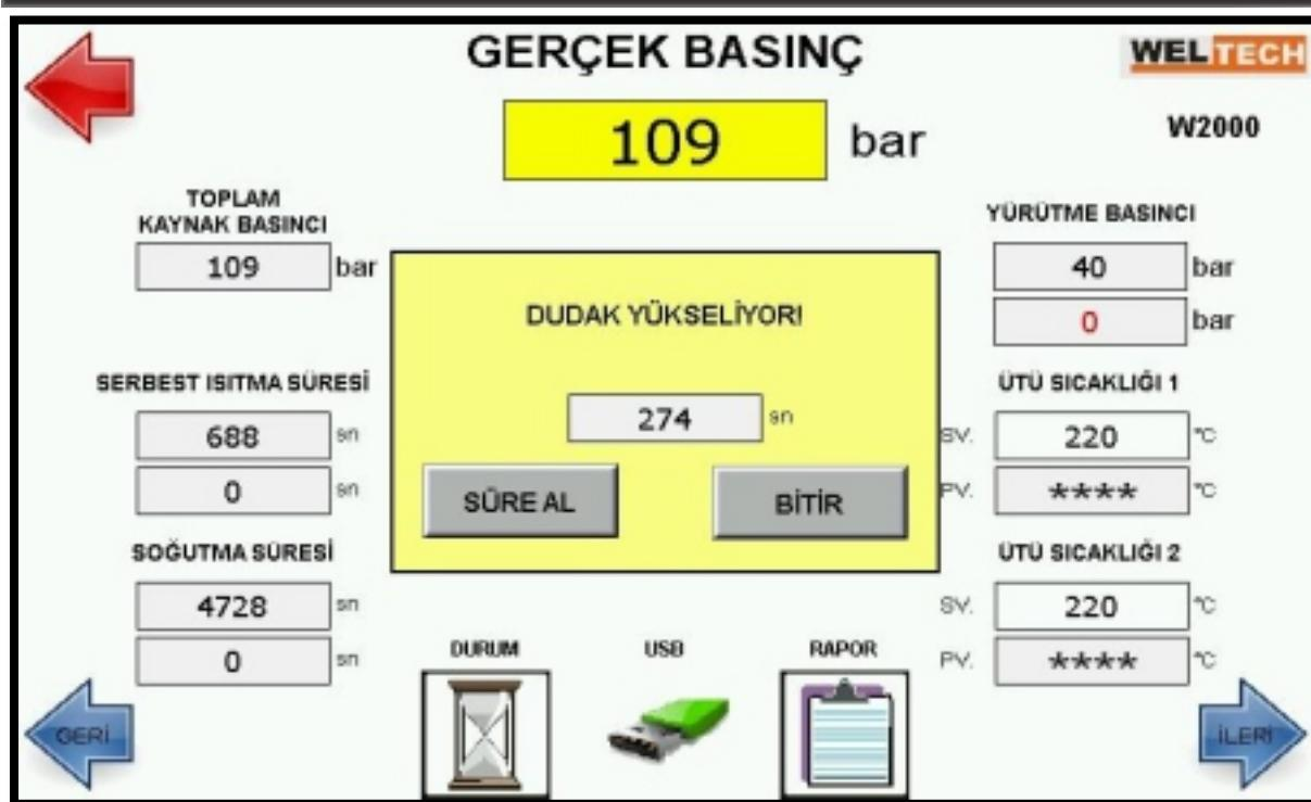
16- CNC W500 K SERİ Alın kaynak makinesi dudak yüksekliği standart değere geldiği zaman basınçsız ısıtma işlemine otomatik olarak geçer. İstenen dudak yüksekliği sağlanmamışsa ekrandaki uyarı çıkar buna göre basınçlı ısıtma süresi devam eder. Dudak yüksekliği standart değere
