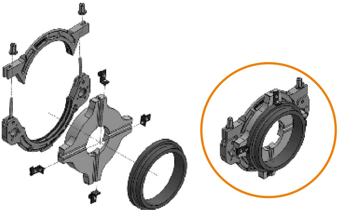
**Şekil 1.** Flanş adaptör paftasının kullanılması
