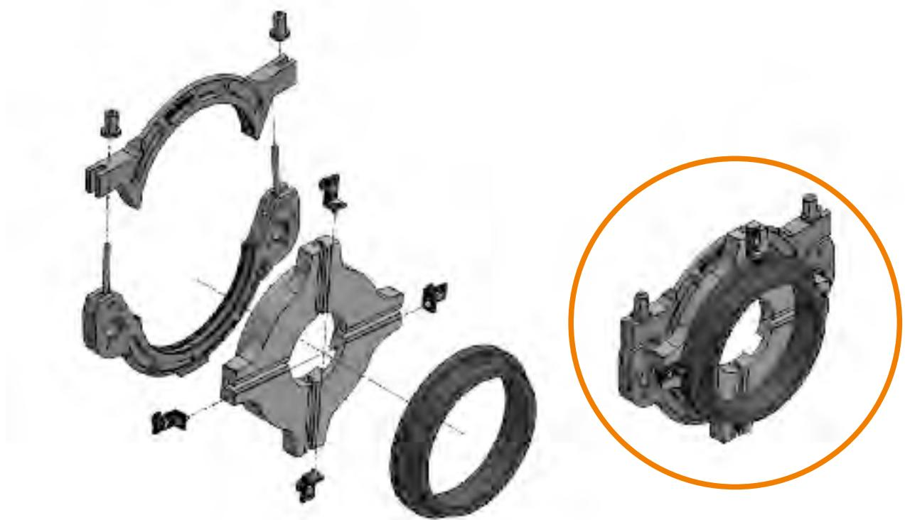
**Şekil 1.** Flanş adaptör paftasının kullanılması
