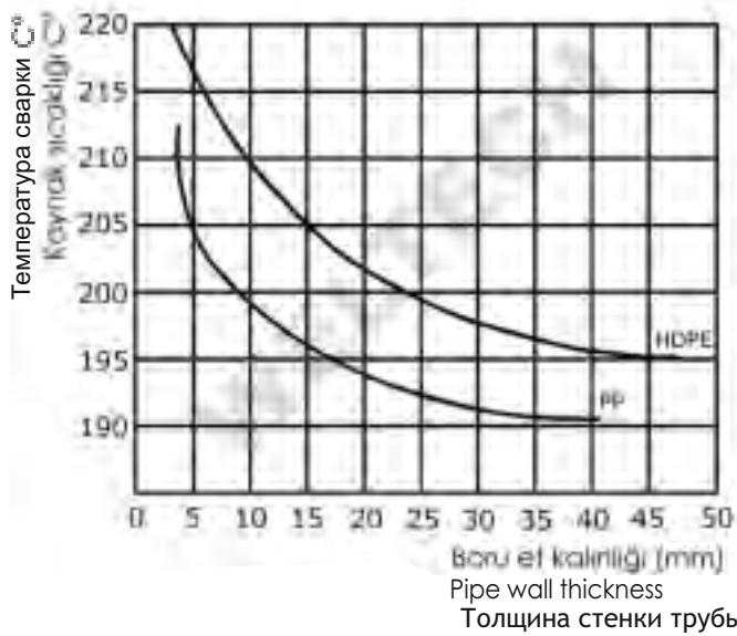
**T.01 Boru et kalınlığı - kaynak sıcaklığı tablosu.**
