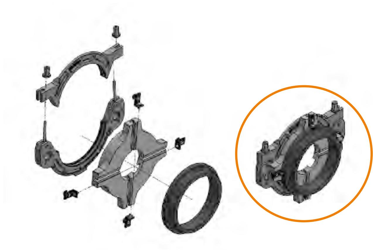
**Şekil 1.** Flanş adaptör paftasının kullanılması
