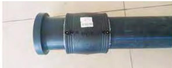
**Hızalama:** İyi bir kaynak işlemi gerçekleştirmek için borular ve ek parçalar manşon ile düzgün bir şekilde hizalanmalıdır. Kaynak sırasında, ısıtma ve soğutma süreçlerinde, borular asla oynatılmamalı ve yerleri değiştirilmemelidir. Bu nedenle, kaynak ve soğutma işlemi sırasında bu tür hareketlerden kaçınmak için, manşon boruya ve ek parçaya kelepçe ile sabitlenmelidir.
