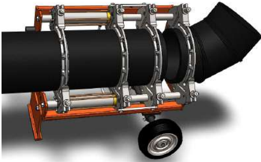
Düz boru ve dirsek borunun bağlantı şekli Installation of straight pipe and an elbow Сварка трубы к отводу
