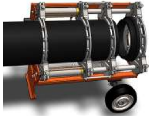
Düz boru ve flanş adaptörü bağlantı şekli. Flanş adaptörünü makinaya bağlamak için flanş aparatına ihtiyaç vardır. (Şekil 1) (Installation of straight pipe and stub end flange adaptor. To do this you need to use flange adaptor clamp. (Fig. 1)) Сварка трубы с втулкой. На рис.1. показана как закрепляется
