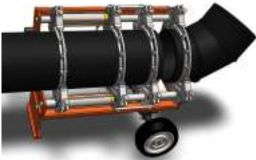
Düz boru ve dirsek borunun bağlantı şekli Installation of straight pipe and an elbow Сварка трубы к отводу
